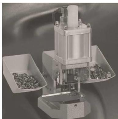
*Рис.133. Принтер для печати по текстилю Рис.134. Пресс для установки на одежду крючков, петель, пуговиц*
