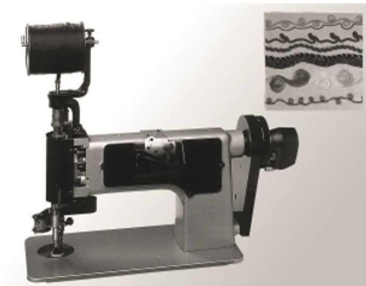
*Рис.138. Вышивальная машина с ручным управлением*
