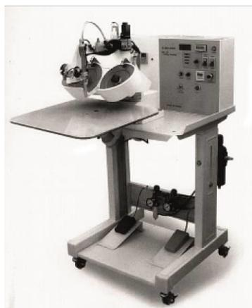
*Рис.131. Ультразвуковая установка для прикрепления фурнитуры одежде*
