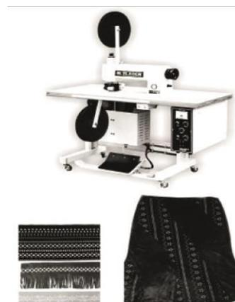
*Рис.132. Машина для отделки плотных материалов*
